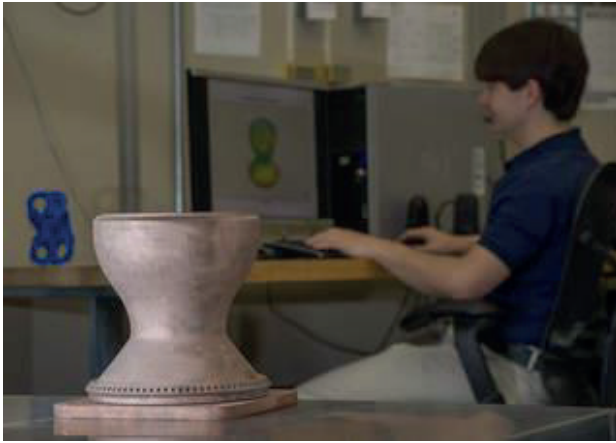
Şekil 3.3. NASA'nın İlk Tam Ölçekli Bakır roket Parçası [85]
