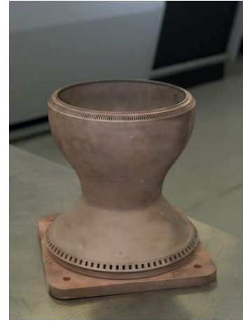
Şekil 3.3. NASA'nın İlk Tam Ölçekli Bakır roket Parçası [85]
